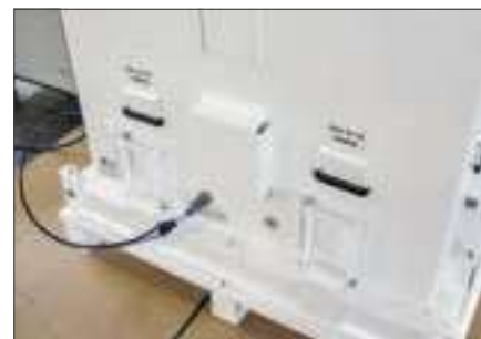
Wasserdampfdichter Behälter bei Dichtheitsprüfung durch Überdruck
