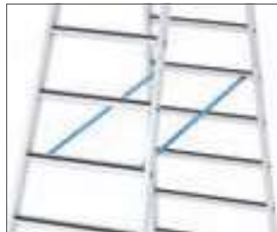
Robuste Anbringung der Gurtbänder
