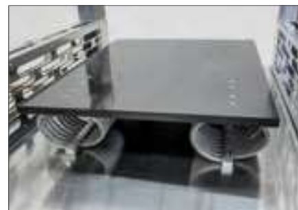
Aufnahmetisch, schwingend gelagert mit Gummipuffer oder Drahtseildämpfer
